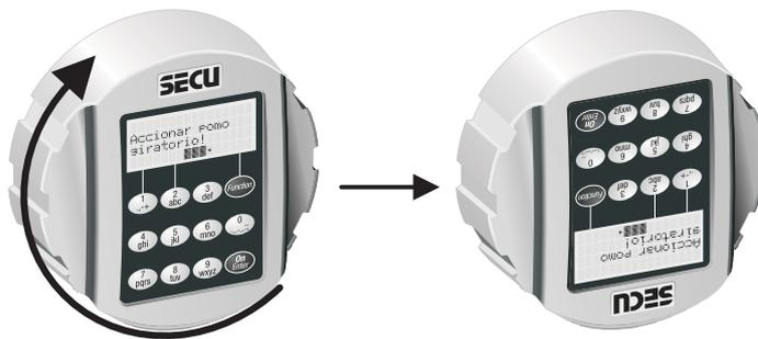
2. Cuando la ventana de apertura de cinco segundos ha finalizado y se gira la botonera hacia atrás hasta el tope (en el sentido contrario al de las agujas del reloj), la cerradura anulará la operación de desbloqueo. Después, se deberá repetir la introducción del código de apertura para habilitar de nuevo la cerradura.
