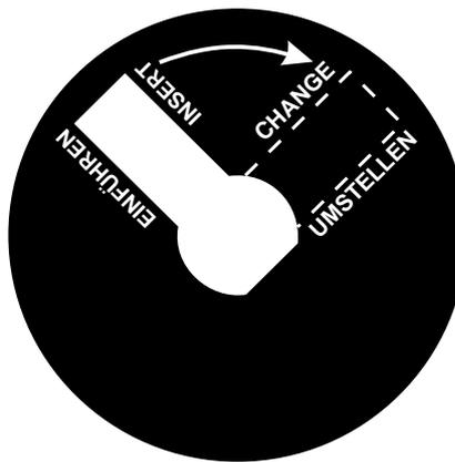
Jetzt führen Sie den Umstellschlüssel vorsichtig bis zum Anschlag in das Schlüsselloch (Türinnenseite) ein und drehen den Schlüssel **RECHTS** herum bis zum markierten Anschlag.
